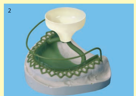
Cienkie kanały odpowietrzające i redukujące ciśnienie wewnątrz pierścienia.
