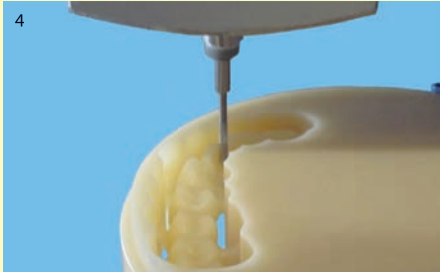
Frezowanie Maszyna frezuje most z blocka bre.CAM.resin.
