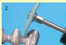
1 Stopy Au, Pd; CrNi Pełne diamenty ceramiczne także dobrze zbierają stopy szlachetne i nieszlachetne.
