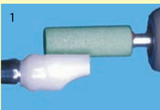
1 Walec jest przeznaczony do obróbki prostych powierzchni.
