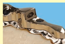
3 Kontrola zpasowania konstrukcji metalowych.
